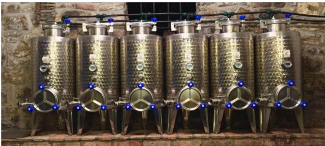
Fig. 15 - Serbatoi di microvinificazione da 100 litri utilizzati per la sperimentazione (Archivio fotografico A. A. Muzic)
