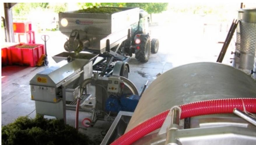
Fig. 5 - Sistema di scarico delle uve, diraspatura, pigiatura, pompaggio, raffreddamento e caricamento della pressa per la macerazione pellicolare (Archivio A.A. Muzic, 2011)
